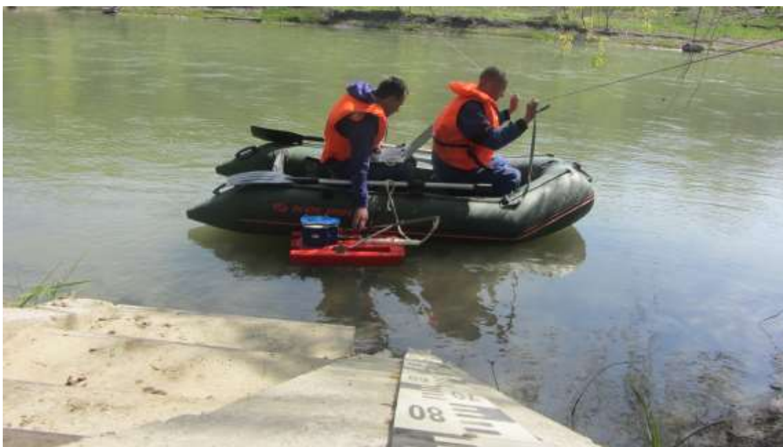
Fig. nr.2 Măsurarea debitului de apă cu ajutorul StreamPro ADCP
